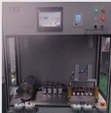
高压直流继电器检测
